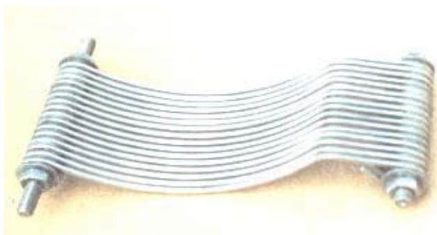
Рисунок 2 – Загальний вигляд дуговидного підсівного решета і лопатевого ротора дослідного пневморешітного сепаратора зерноочисної машини Джерело: розроблено авторами
