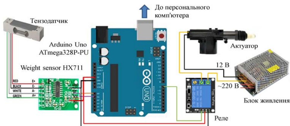
Рисунок 4 – Електрична схема керування блоку вимірювання об'ємної маси
