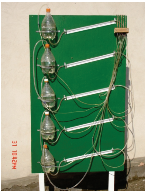
Рис. 3.5. Батарейний мікроманометр: а) – загальний вигляд; б) – «батарея» трубок Піто-Прандля
