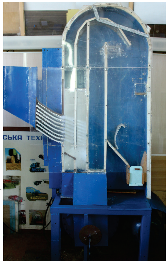
Рис. 3.4 Схема та загальний вигляд експериментальної установки для дослідження ПСК з живильним пристроєм для багаторівневого введення зернового матеріалу
