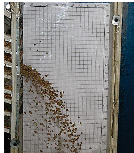
Рис. 3.2. Схема та фото визначення швидкості введення зерна
