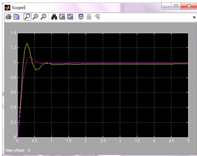
Рис. 4.14. Якість роботи нечіткої нейронної системи автоматичного керування холодопродуктивністю компресора в порівнянні з ПІД регулятором.
