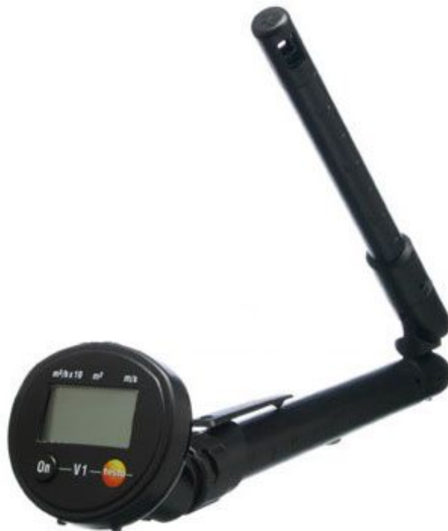
Рис. Б.6. Загальний вид термоанемометра Testo-405-V1.
