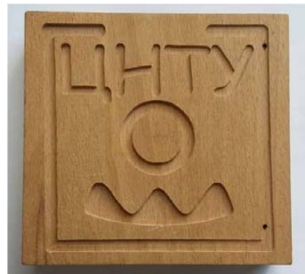
Рис. 22. Обробка деталі на БВПС зі спеціальним РО
