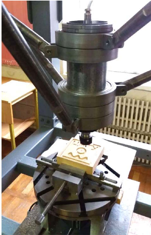
Рис. 22. Обробка деталі на БВПС зі спеціальним РО
