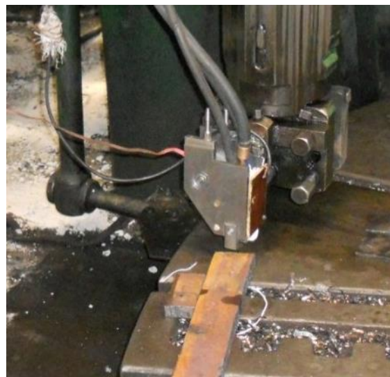
Рис. 2.2. Схема пристрою (а) та експериментальна установка (б) для ППДЗ
