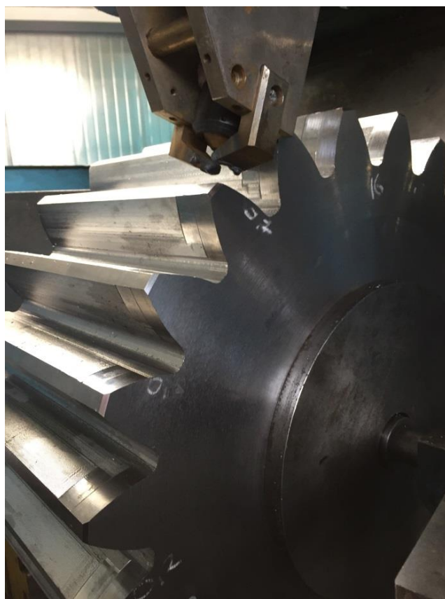
Рис. 5.3. Процес обробки вал-шестірни методом ППДЗ в умовах виробництва
