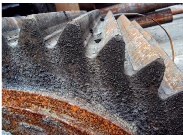
Рис. 1.2. Зношення евольвентного профілю вал-шестірні приводу кульового млина МШЦ 40х50
