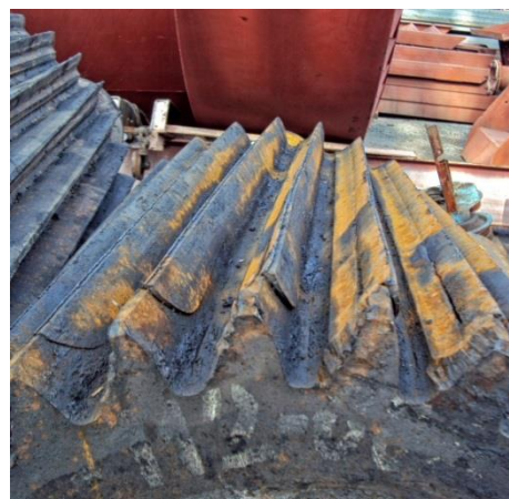
Рис. 1.4. Неприпустимі форми контакту зубів і поломка зубів
