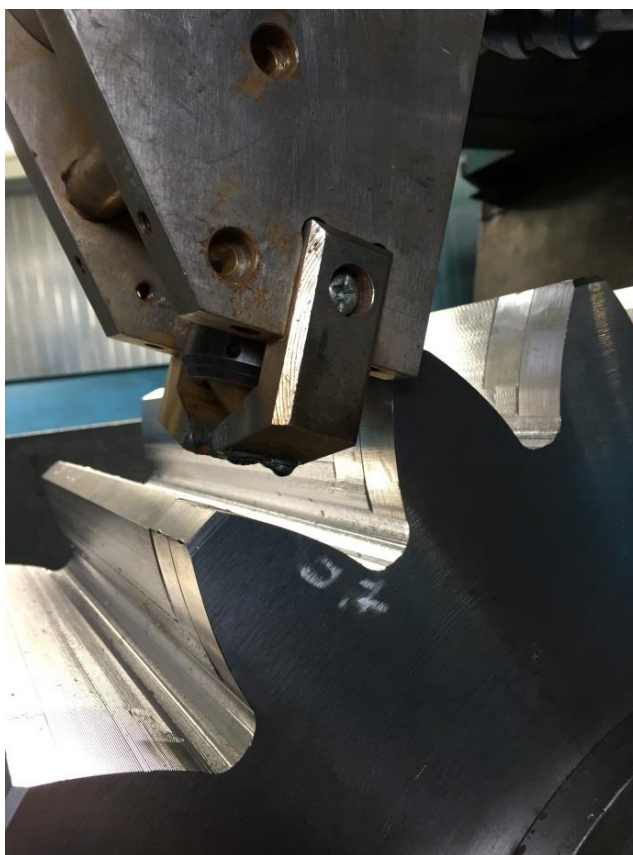
Рис. 5.3. Процес обробки вал-шестірни методом ППДЗ в умовах виробництва
