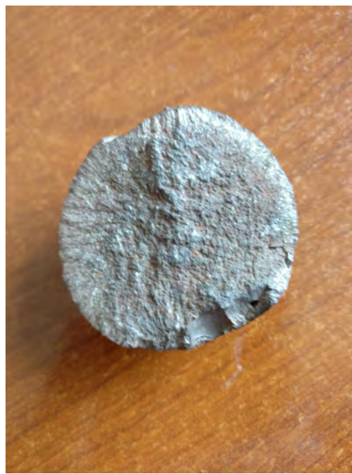
Рисунок 5 – Злом виливка молольної кулі (Ø30 мм)
