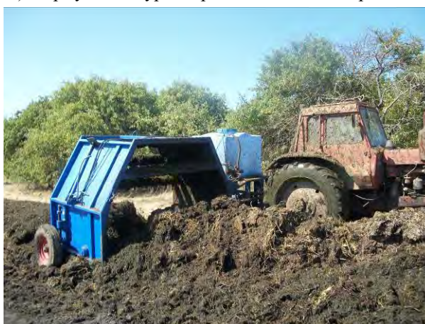
д) Формування буртів агрегатом МТЗ-80 з ходозменшувачем та аератором-змішувачем з одночасним подрібненням та змішуванням сировини
