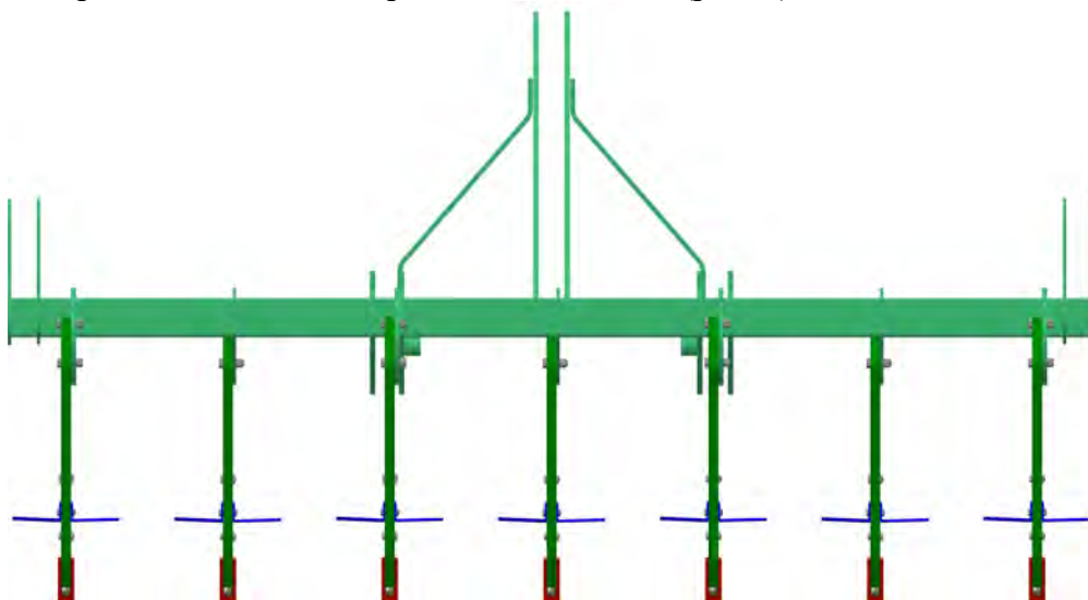
Рисунок 3 – Розміщення чизельних лап на рамі глибокорозпушувача у фронтальній площині
