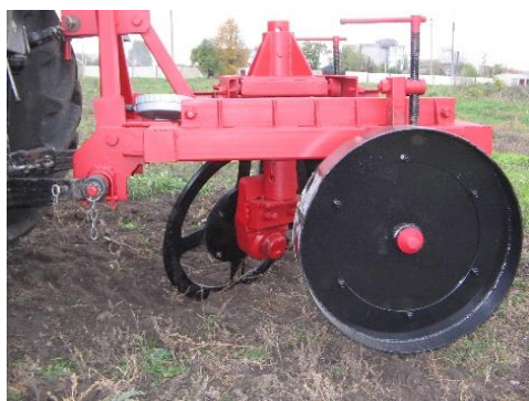
Рис. 1. Конструктивна схема (а) загальний вид (б) і (в) механізм зміни кутів постановки диска тензометричного візка:
