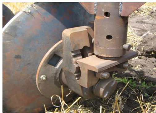
Рис. 1. Конструктивна схема (а) загальний вид (б) і (в) механізм зміни кутів постановки диска тензометричного візка:
