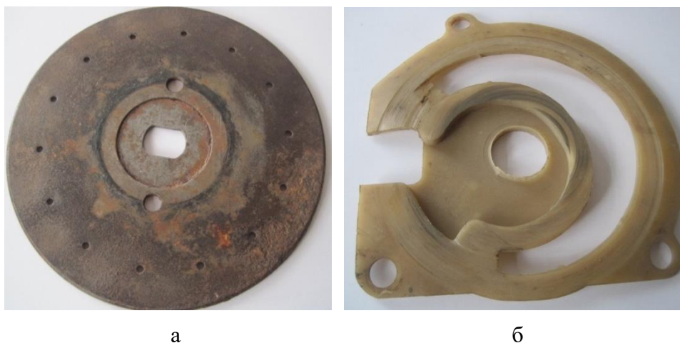
Рис. 1. Высевальной диск (а) с прокладкой (б) высевального аппарата Н 126.13.000 сеялок типа СУПН
