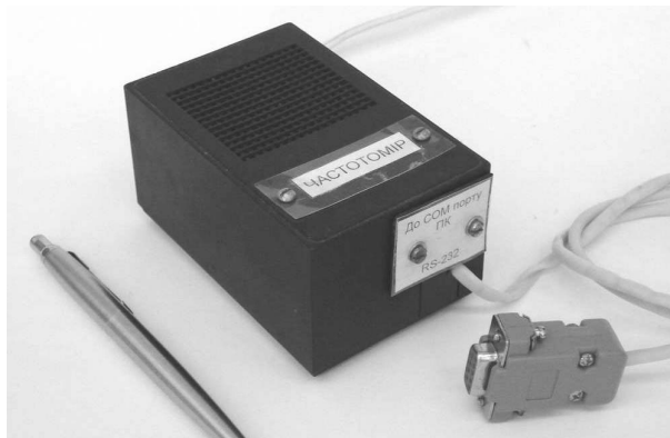
Рисунок 1. Пристрій для вимірювання девіації частоти в енергосистемі
