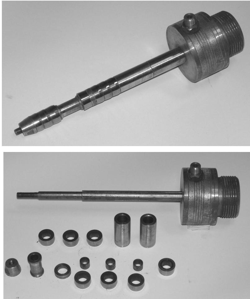
Рисунок 2. Загальний вид комбінованої протяжки для обробки робочої порожнини гальмівних циліндрів
