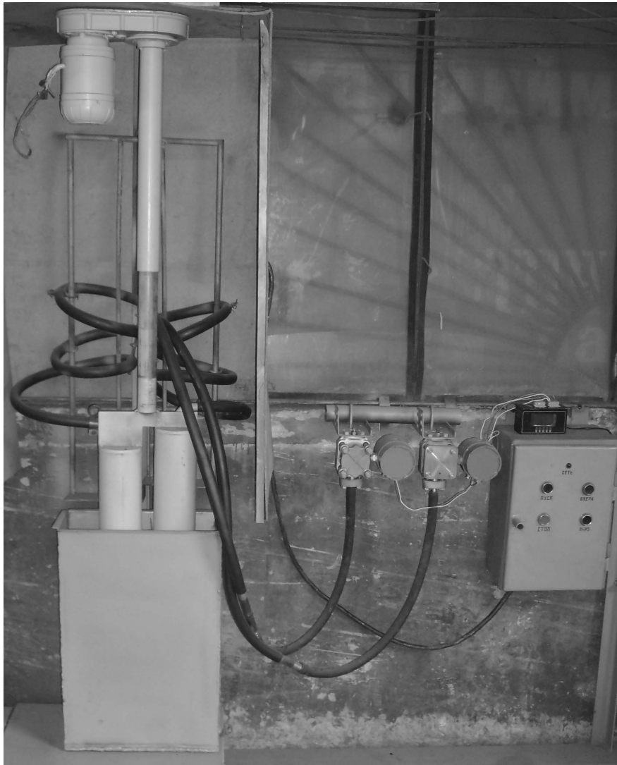
Рисунок 1. Стенд для випробування системи комп'ютерної ідентифікації співвідношення руда/вода при подрібненні пісків класифікатора
