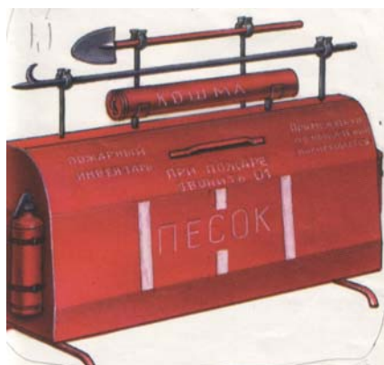
Рис. Пожежний щит
