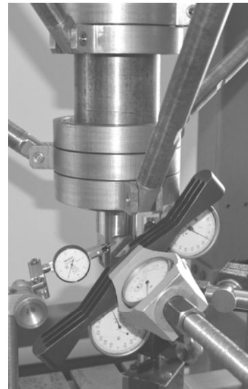
Рис. 2.27. Дослідний стенд для вимірювання переміщень РО при навантаженні вздовж осі Y
