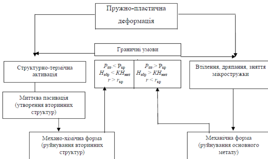
Рисунок 1. Механізми і граничні умови абразивного зношування (за даними Б.І. Костецького)
