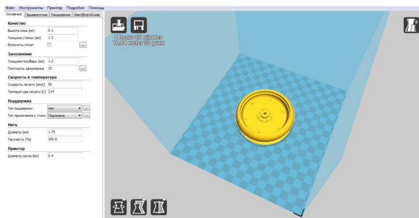
Рис. 4. – Підготовка 3D моделі до друку у програмі Cura 15.04.3.
