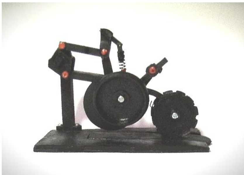
Рис. 5. – Роздрукована модель посівної секції комплексу Turbosem II 19-60 у масштабі 1:10.
