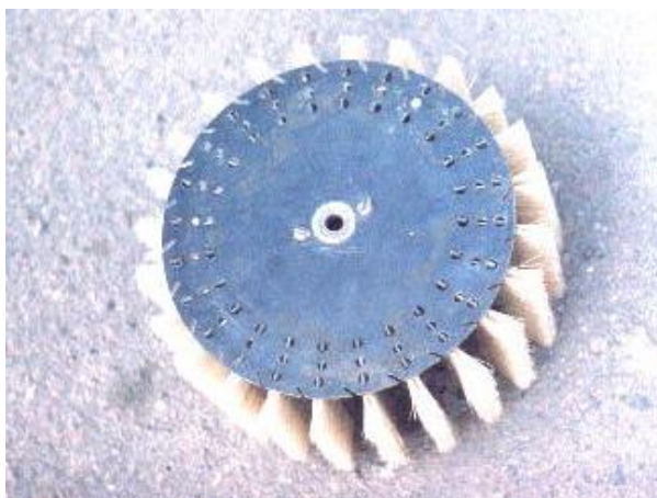
Рис. 2. Загальний вигляд дослідного лопатевого барабану.
