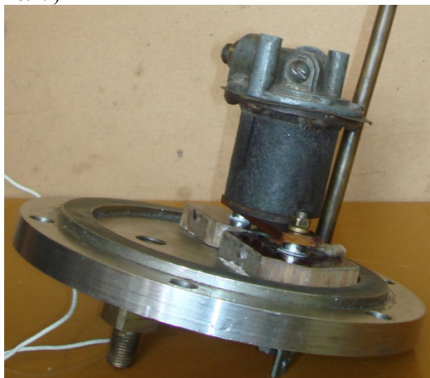
Рис.1. Загальний вигляд імпульсно-барботажного низьковольтного перемішувачого пристрою
