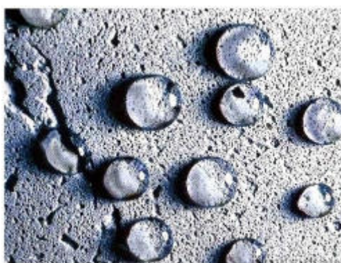
Рисунок 2 – Запобігання проникненню води
