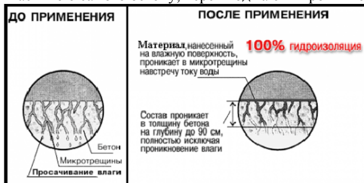
Рисунок 5 – Принцип дії проникаючої гідроізоляції.
