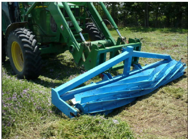
Рисунок 2 – Коток-подрібнювач з шевронним розташуванням ножів-лез конструкції Ted S. Kornecki (Агроінженерний коледж університету штату Алабама, США) [2]
