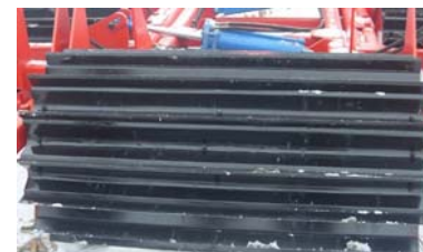
Рисунок 4 – Коток-подрібнювач під час польових випробувань [5]
