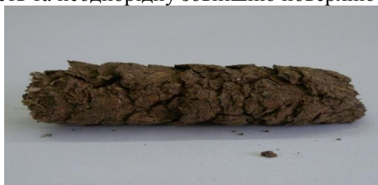
Рис. 2. Вигляд пелет з листя горіху, вологістю 14% та тирси вологістю 30% з діаметром 5 та 10мм при застосуванні матриці з короткою циліндричною частиною 10мм.
