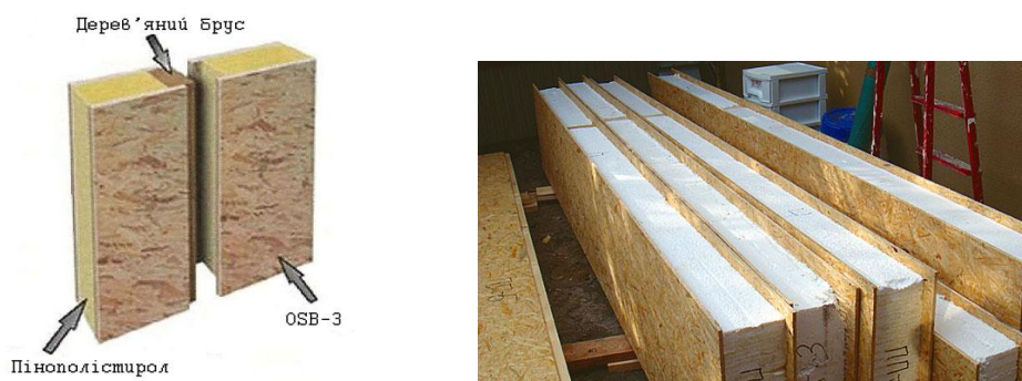
Рисунок 2 – Загальний вигляд SIP-панелі.
