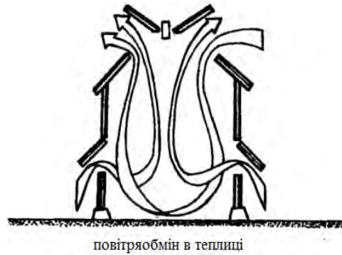
Рисунок 3 – Витяжна система теплиці і потоки руху повітря в ній
