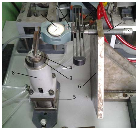
1-індикатор; 2 – гвинт; 3 – цанга затисна; 4 – заготовка з прапорцем ; 5 – пневмоциліндр; 6 – кронштейн; 7 – динамометр; 8 – корпус.
