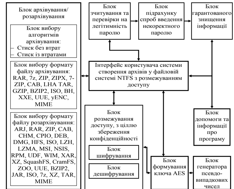
Рисунок 1 – Функціональна схема ПЗ архівування у файлової системі NTFS з розмежуванням доступу
