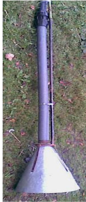
а) 1 – повітропровід; 2 – форсунки; 3 – кільцевий напірний повітропровід; 4 – корпус змішувач (забірний пристрій); 5 – підйомна труба; 6 – розподільний вивідний рукав.
