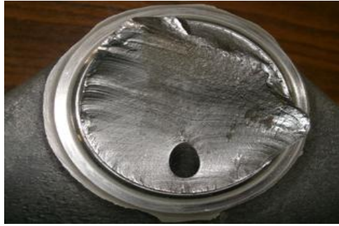
Рисунок 3 – Втомний злам колінчастого валу
