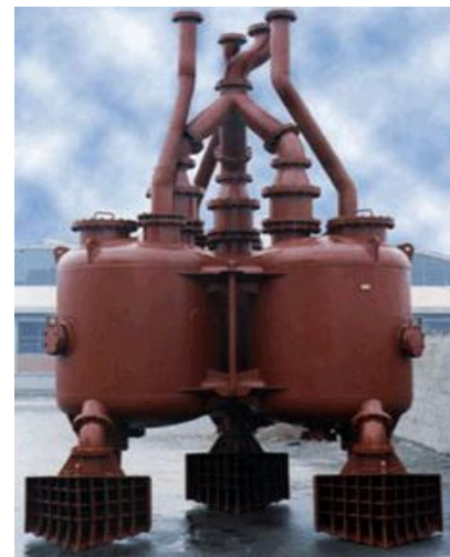
а) 1 – робоча камера, 2 – забірний пристрій, 3 – клапан; 4 – труба входу і виходу повітря, 5 – вивідний трубопровід.
