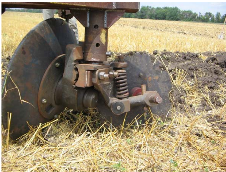
Рисунок 4 – Механізм кріплення диска до стояка
