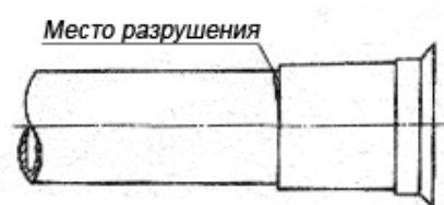
Рисунок 4 – Разрушение в зоне ниппеля
