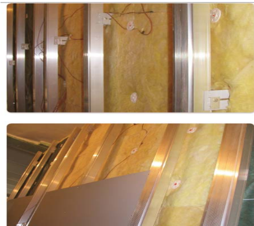
Рисунок 2- Вигляд стінових конструкцій з використанням виробів ISOVER під час їх монтажу в кліматичній камері
