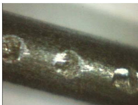
Рисунок 2 – Сварочная проволока со следами насечки (x200)
