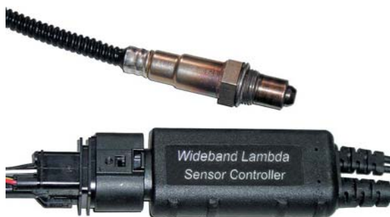
Рисунок 1 – Широкопasmовий лямбда-зонд та контролер
