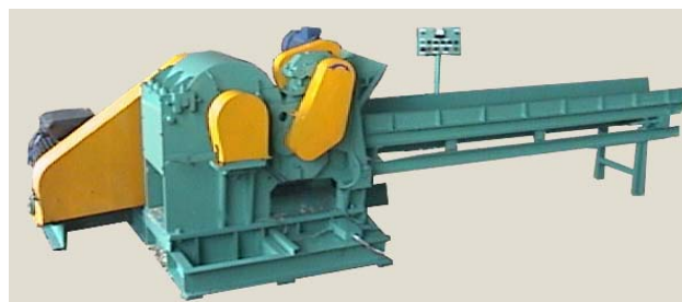
1-станина; 2-сітка; 3,6-контрножі; 4-кришка; 5-ротор; 7,8-механізм подачі; 9- конвейер
