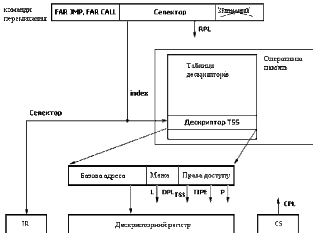
Рисунок 2 – Схема основних перевірок і процедура вибору цільового TSS при прямому перемиканні задач
