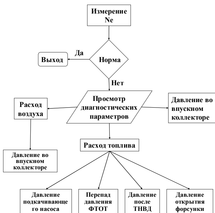
Рисунок 1 – Методика определения технического состояния силовой установки
