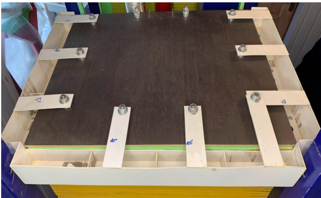
Рисунок 4.5 – Приймач фракцій насінневого матеріалу після віброфрикційного розділення
