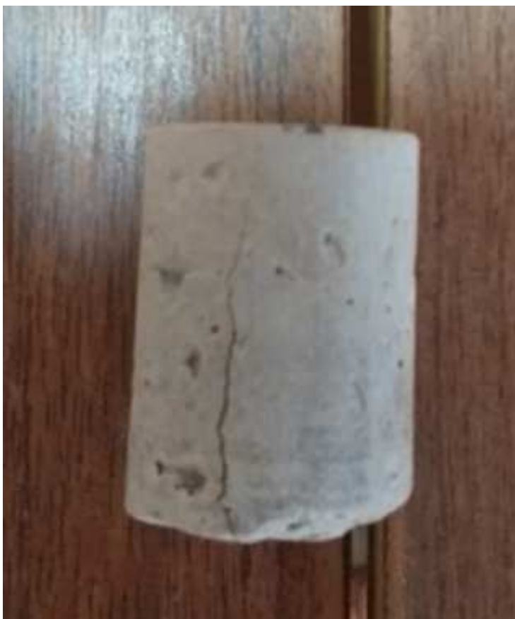
Рисунок 1- Загальний вид зразка ґрунтоцементу з додаванням 20% золи виносу після прикладання руйнівного навантаження
