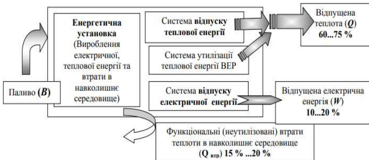
Рисунок 1 – Структура процесів когенераційної установки
