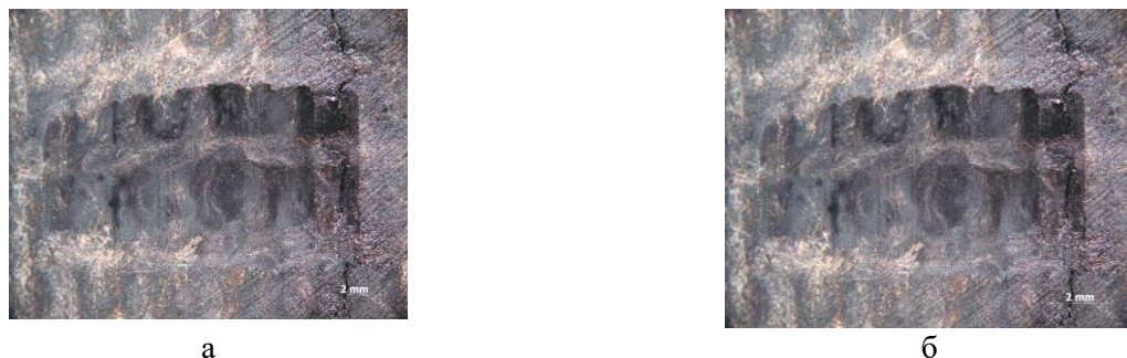
Рисунок 2 – Спрацювання текстолітових шибєрів в парі з чавуном а) та покриттям, обробленим платовершинним хонінгуванням б)
