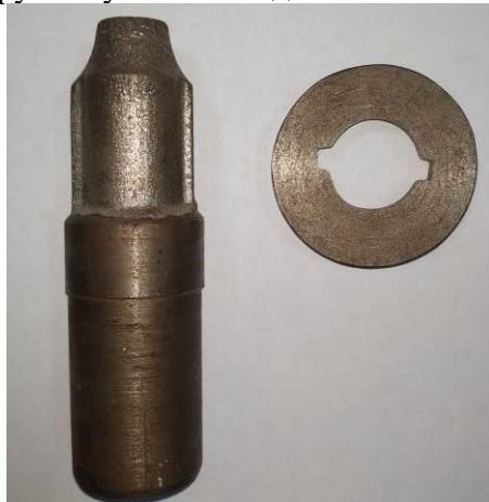
Рисунок 1. Знос електрод-інструмента зі сталі 20 при РОД наскрізного отвору
