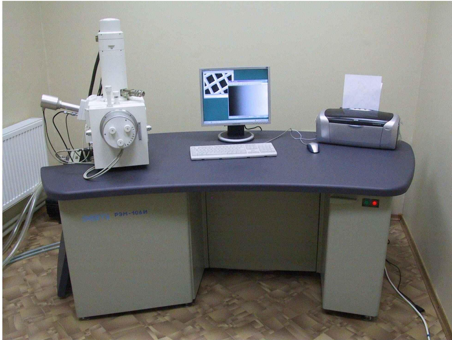
Растровий електронний мікроскоп моделі РЕМ - 106И з камерою низького вакууму та системою енергодисперсійного мікроаналізу
