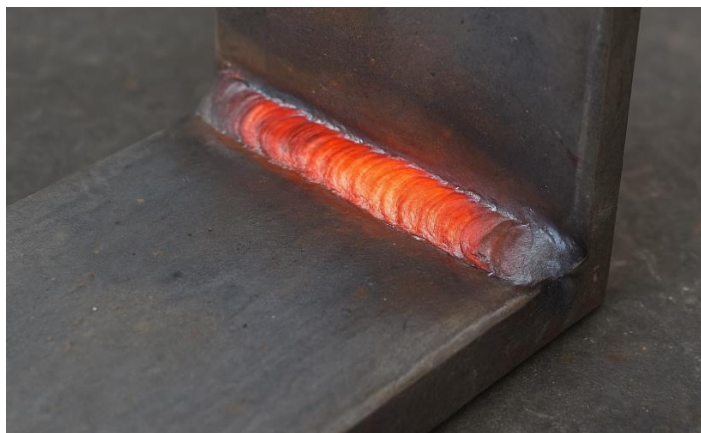
Рисунок 2 - Зразок зварного шва та зони термічного впливу на поверхні металу
