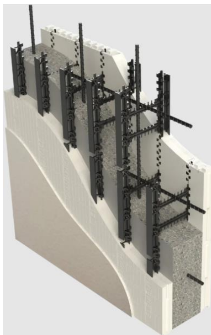
Рисунок 1 – Фрагмент стіни виконаної в незнімній опалубці систем ICF (Insulated Concrete Formwork).
