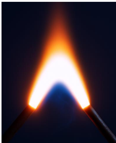
Рисунок 2 - Контакт зварювальних електродів і утворення дуги.
