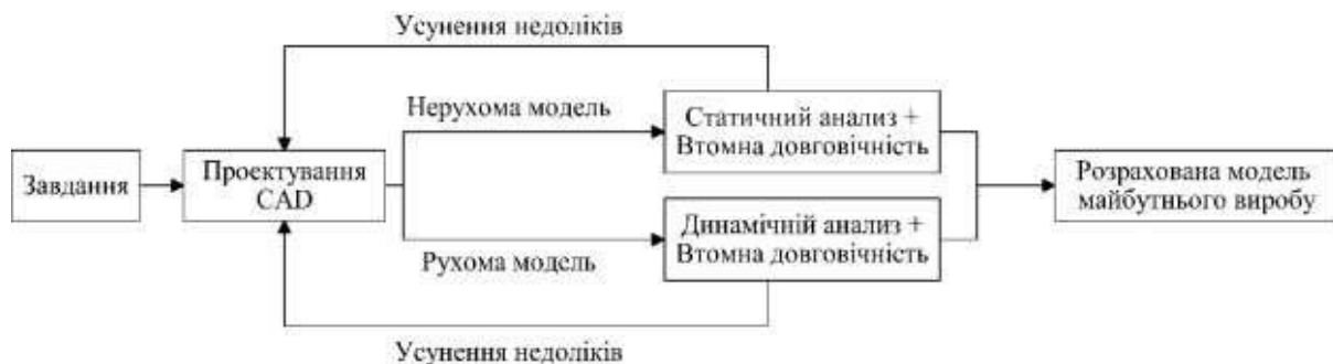
Рисунок 1- Етапи проектування несучої системи за допомогою програми ANSYS
