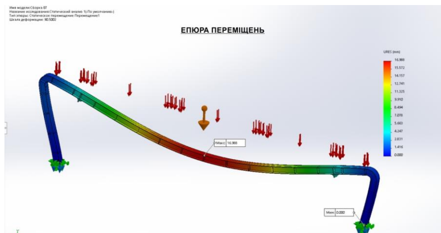
Рисунок 6 - Графічне зображення розподілу переміщень несучої балки
