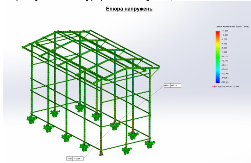
Рисунок 8 - Графічне зображення напружень в елементах каркаса, в якому впроваджено трубу 160x8x4.
