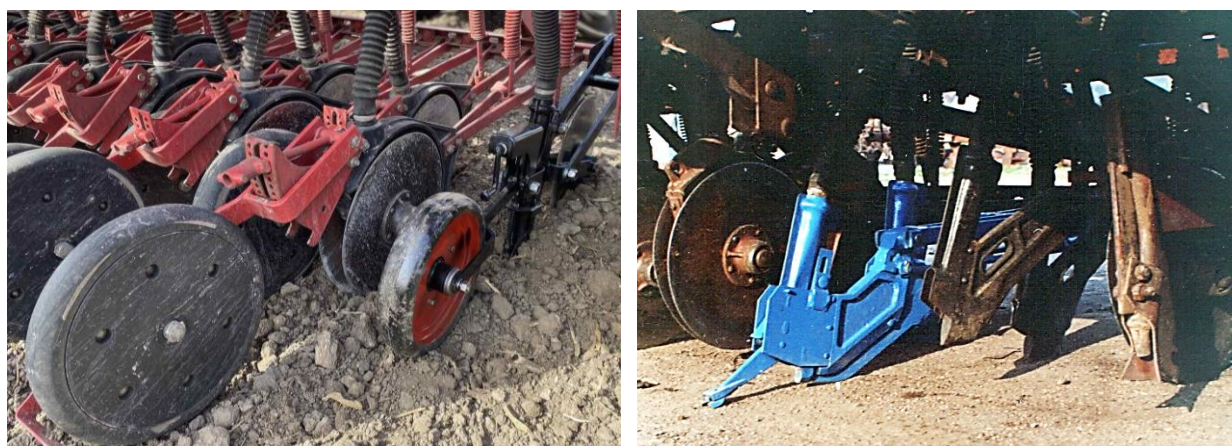
Рис. 3.14. Порівнювані робочі органи в складі сівалок СЗ-3,6
