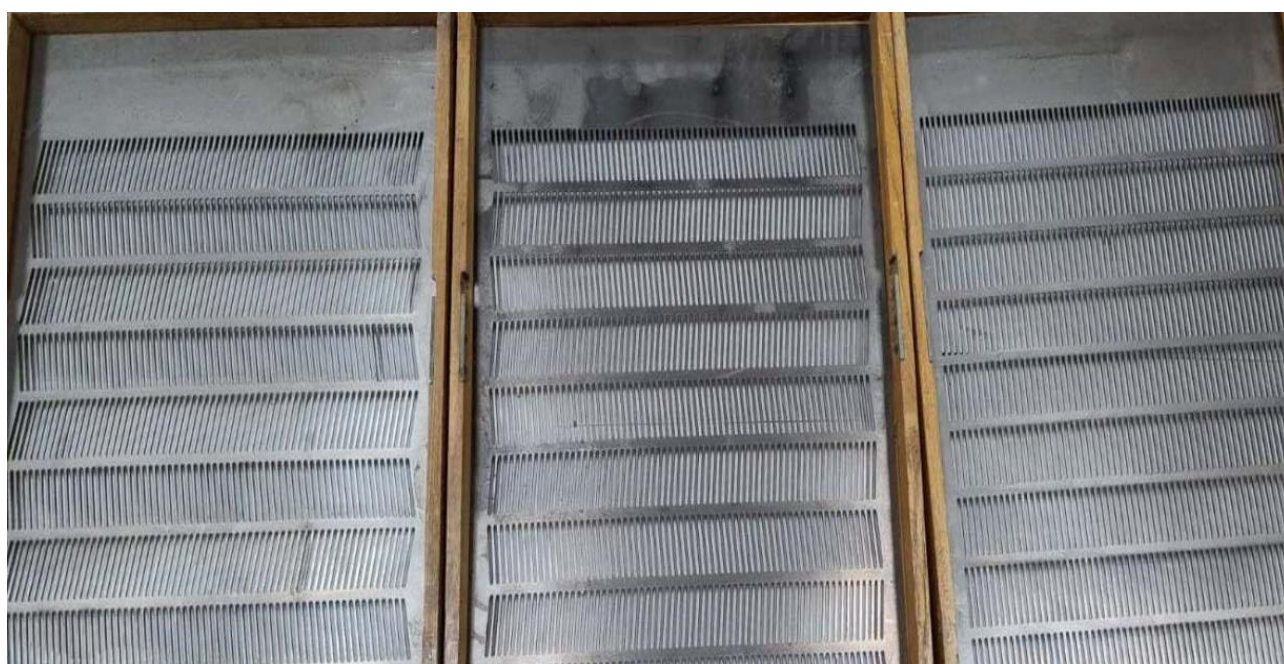
Рис. 3.4. Дослідні решітні полотна із зигзаговидними продовгуватими отворами
