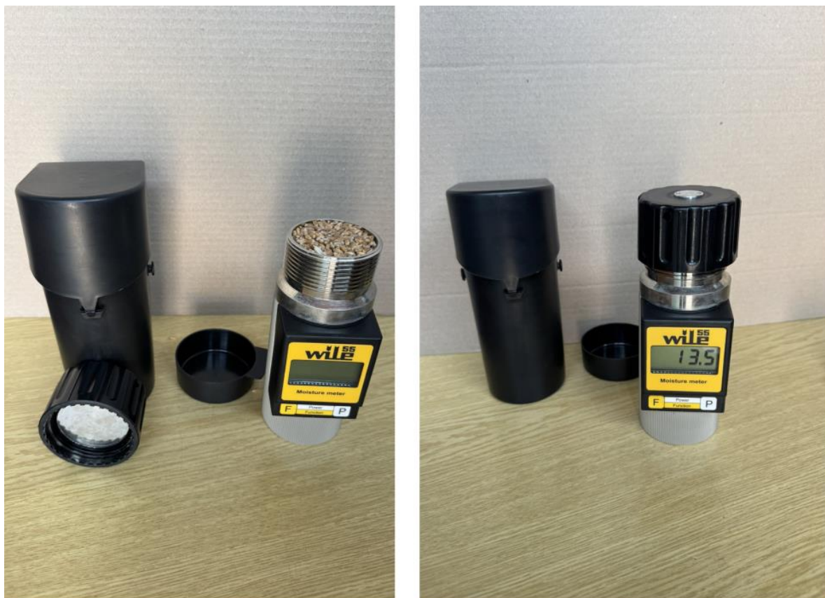
Рис. 3.8. Оцінка вологості зерна вологоміром Wile 55
