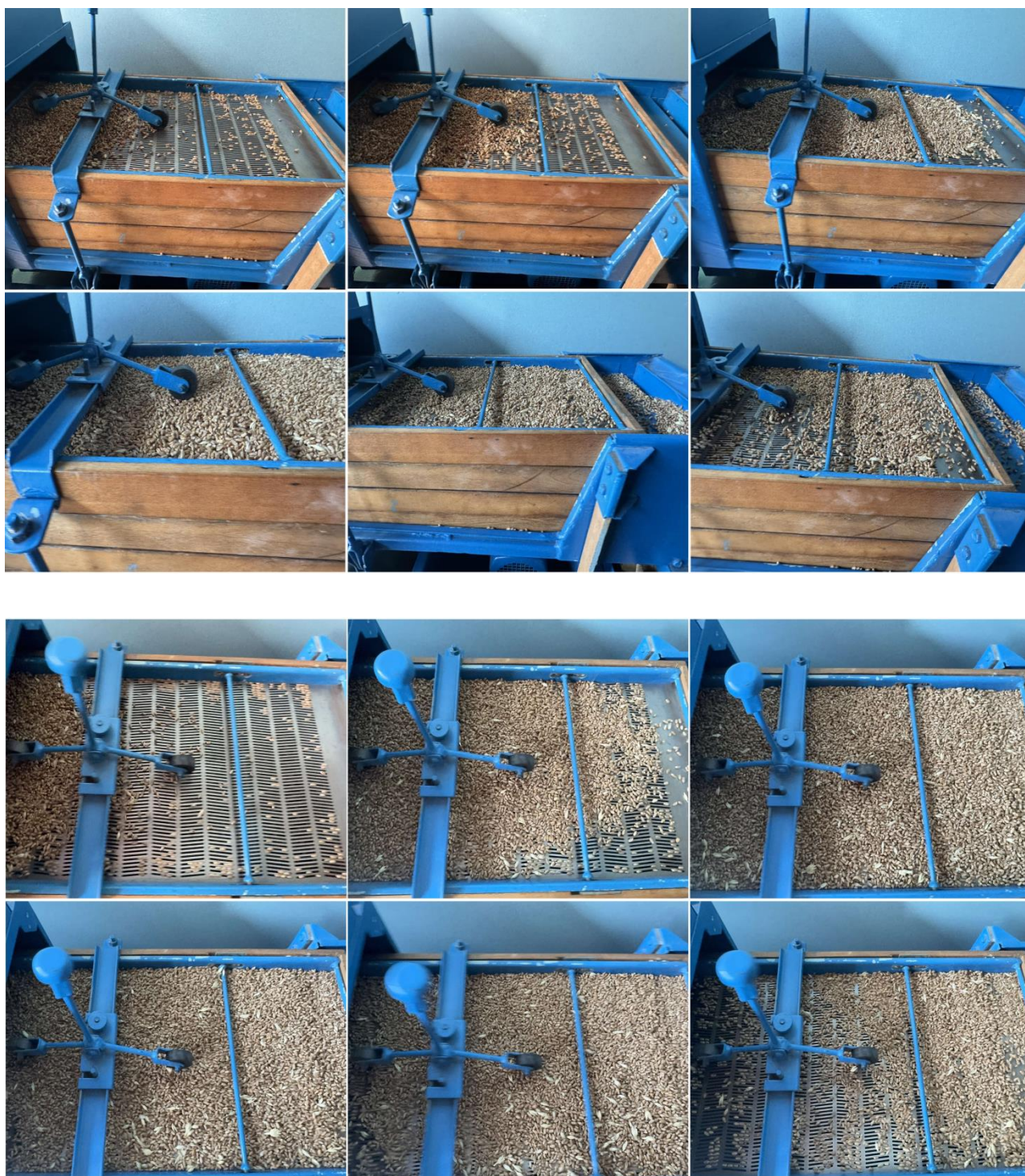
Рис. 3.5. Проведення експериментальних досліджень по вивченню впливу конструкцій решета із зигзагоподібним розміщенням отворів на ефективність очищення на лабораторному сепараторі Petkus Wutha K 294 А
