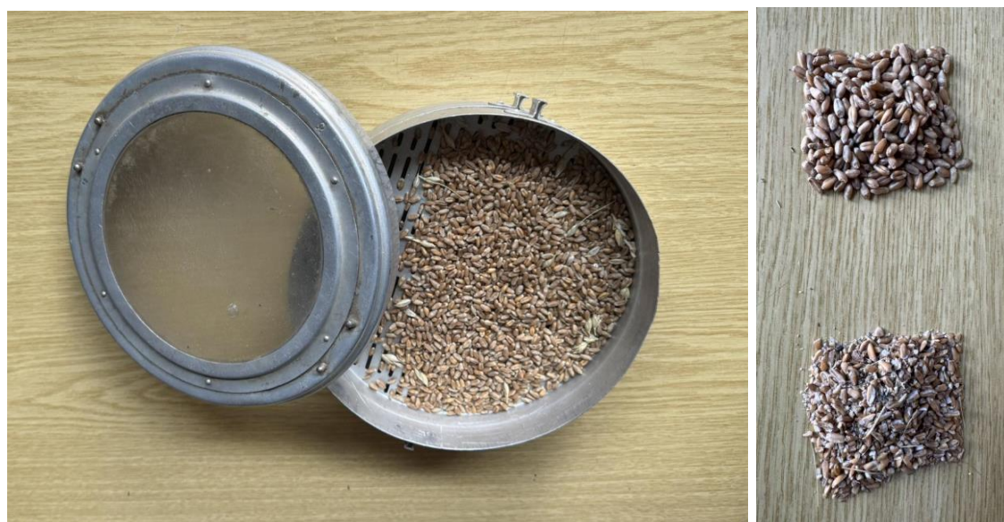
Рис. 3.7. Оцінка вмісту домішок на ручному решітному класифікаторі
