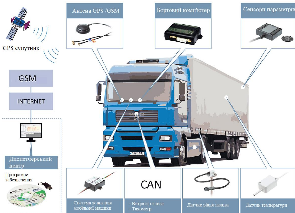
Рисунок 1.7 - Сенсорна система моніторингу мобільної машини
