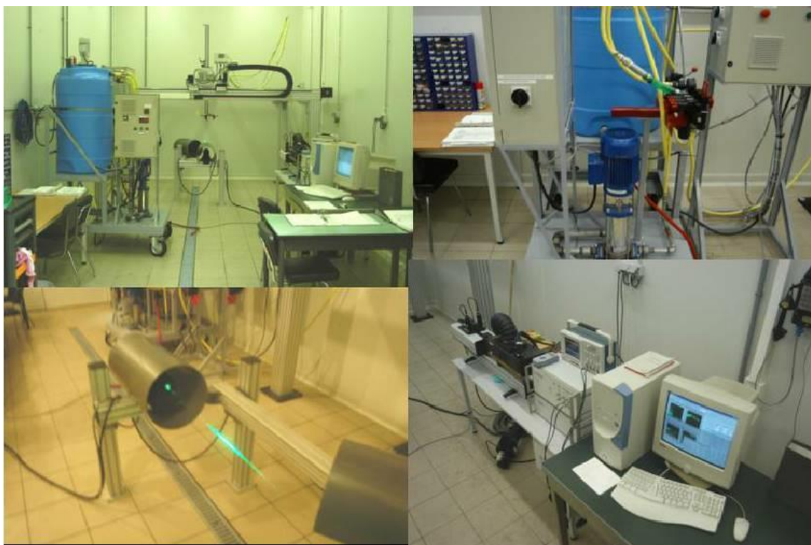
Рисунок 1.18 – Лабораторний стенд PDPA для вимірювання розміру та швидкості крапель
