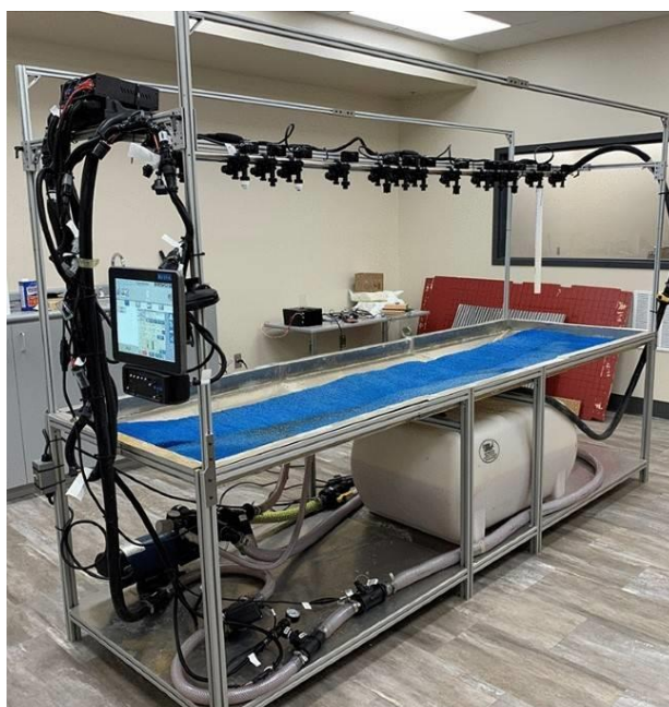
Рисунок 1.19 – Стенд PIV/PLIF для візуалізації факела розпилу [87]
