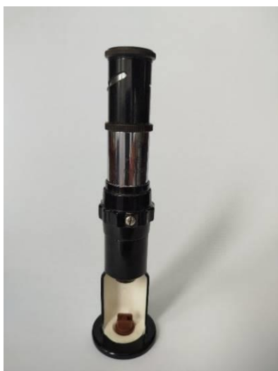
Рисунок 2.9 – Визначення розмірів внутрішніх каналів розпилювача при створенні геометрії розпилювача
